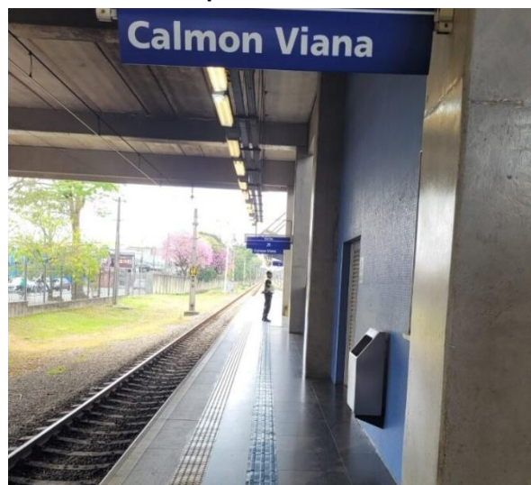
Figura 130 – Rota tátil e sinalização na plataforma
