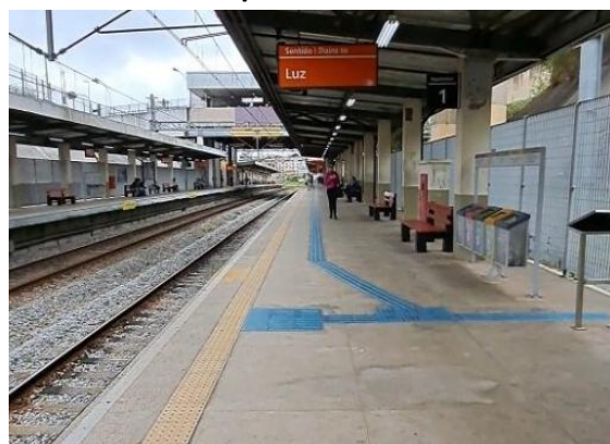
Figura 53 – Rota tátil e sinalização na plataforma
