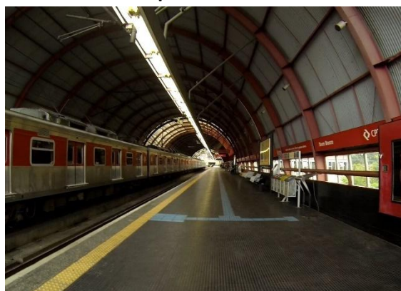
Figura 38 – Rota tátil e sinalização na plataforma
