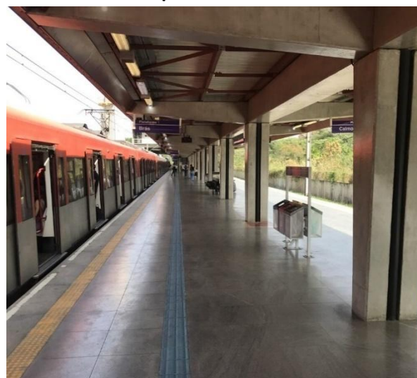
Figura 105 – Rota tátil e sinalização na plataforma
