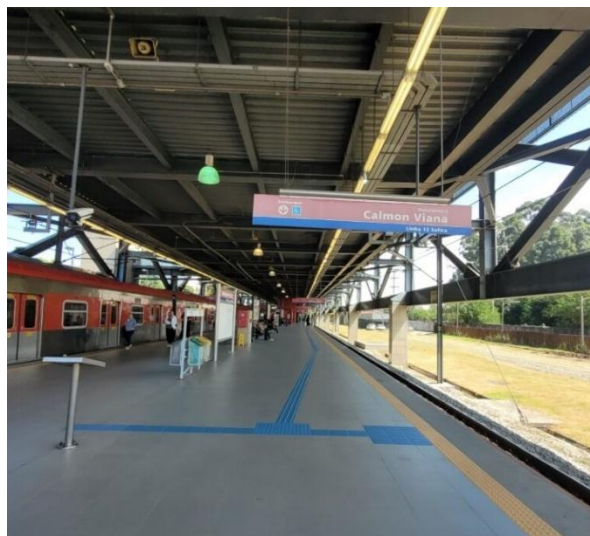
Figura 115 – Rota tátil e sinalização na plataforma
