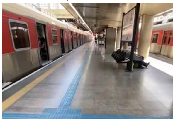
Figura 48 – Rota tátil e sinalização na plataforma
