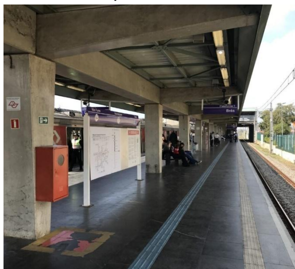
Figura 120 – Rota tátil e sinalização na plataforma
