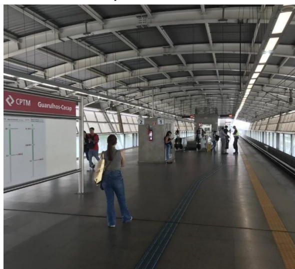
Figura 150 – Rota tátil e sinalização na plataforma
